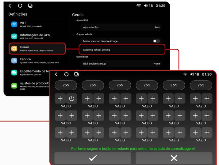
Para selecionar os botões, pressione simultaneamente os botões na multimídia e os botões correspondentes no volante. O botão na central multimídia mudará de cor, indicando que a configuração foi realizada com sucesso.
