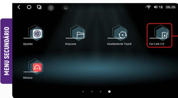
Para utilizar a função CPAA, certifique-se de que o seu dispositivo móvel esteja conectado ao Bluetooth do i-Tablet. Em seguida, clique no ícone "Car Link 2.0" no menu secundário para iniciar a conexão.
