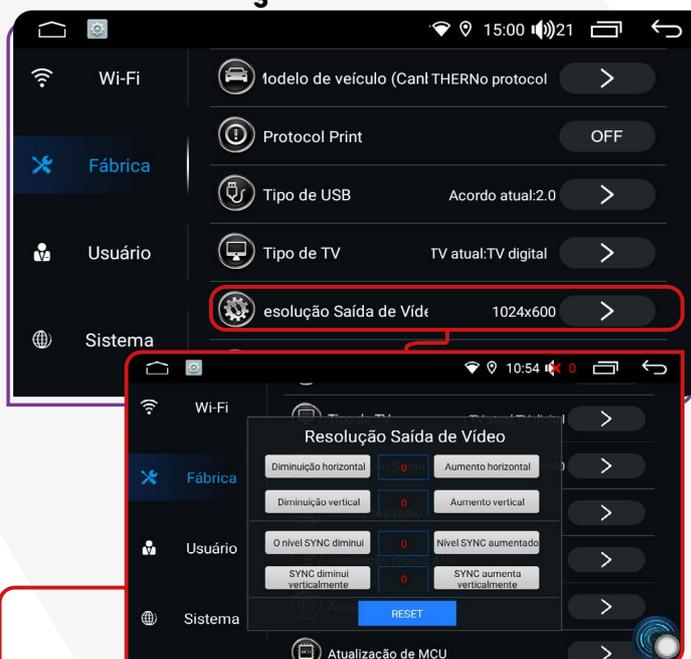
Essa função ajusta tanto o posicionamento vertical quanto horizontal da saída de vídeo.
