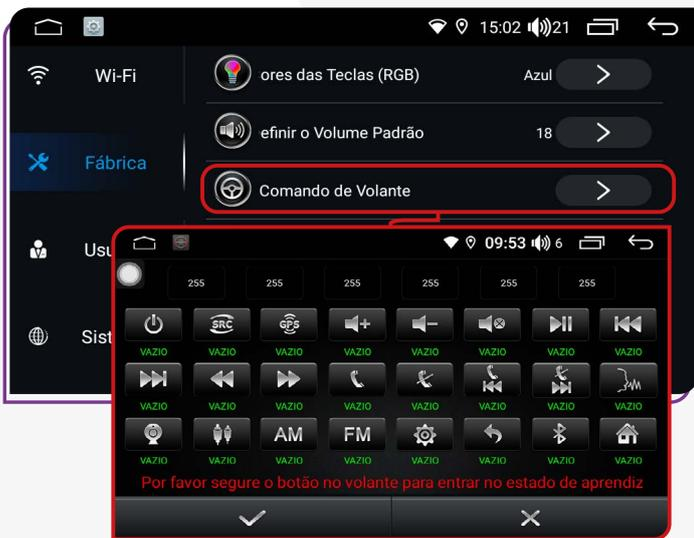
Para veículos que possuem botões de controle no volante, é possível configurar suas funções ativando a opção **"Comando de Volante"**.
