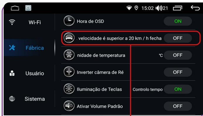
Se o veículo tiver leitura automática da velocidade de fábrica, qualquer vídeo em reprodução será bloqueado ao atingir 20km/h.
