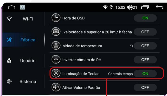
**ON** As teclas da multimídia se iluminarão automaticamente quando os faróis do veículo forem ligados e se apagarão quando os faróis forem desligados.
