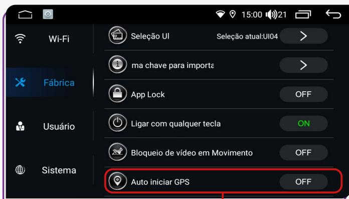
Ao ativar a função "Auto iniciar GPS", ao ligar o carro e o i-Tablet, o aplicativo de GPS previamente instalado e configurado pelo usuário será aberto automaticamente.
