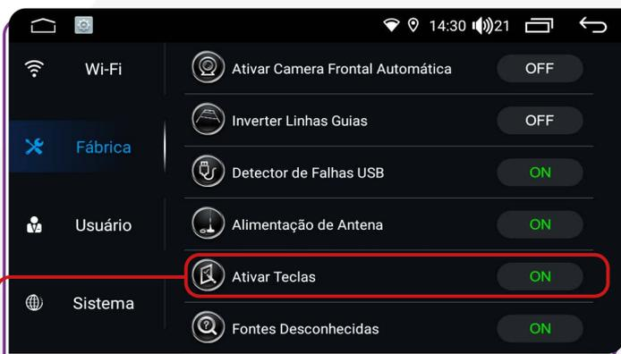
Ativando essa função, você pode ativar e reverter as teclas do volante.
