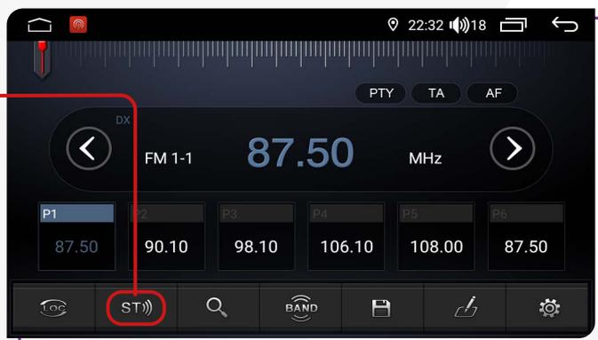
**Seleção de Banda FM:** A linha Próton possui duas frequências, sendo **AM** e **FM**, podendo configurar até 18 FMs e 12 AMs. A frequência FM é composta por 3 bandas (FM1-1, FM2-1 e FM3-1) e a frequência AM é composta por 2 bandas (AM1-1 e AM2-1).
