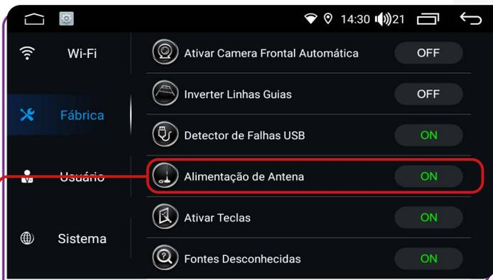
Essa função é recomendada para garantir o funcionamento adequado da antena do amplificador de som, caso o veículo esteja equipado com tal componente.
