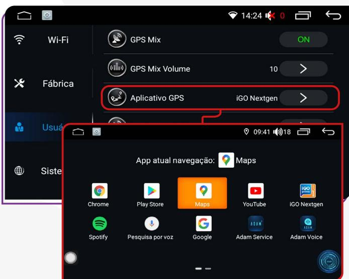
Ao acessar a função "Aplicativo GPS", é possível configurar o aplicativo de navegação GPS que será utilizado na multimídia.
