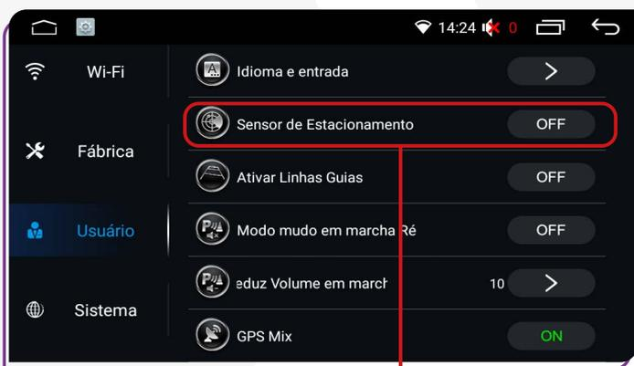
Para veículos equipados com sensor de estacionamento de fábrica, ao ativar essa função no i-Tablet, é possível configurá-la para integração com os sensores do veículo.
