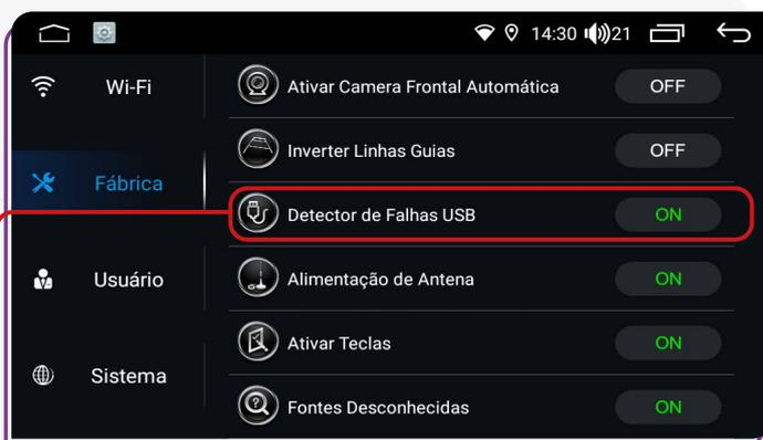
Ao ativar essa função, ao conectar um USB com erros internos (vírus, software, etc.), a multimídia realizará as correções necessárias para garantir o bom funcionamento do USB e do seu i-Cardtablet.
