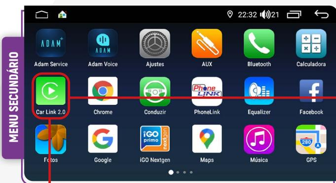
Para utilizar a função **CPAA**, certifique-se de que o seu dispositivo móvel esteja conectado ao Bluetooth do i-Cardtablet. Em seguida, clique no ícone "**Car Link 2.0**" no menu secundário para iniciar a conexão.
