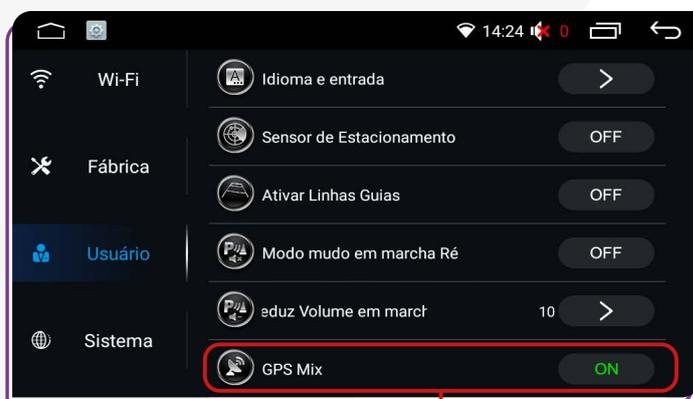
Com a antena GPS instalada no veículo, ao ativar a função **"GPS Mix"**, você pode utilizar os sistemas GPS integrados na multimídia, obtendo uma localização mais precisa e utilizando com maior eficácia os aplicativos de GPS instalados no sistema.
