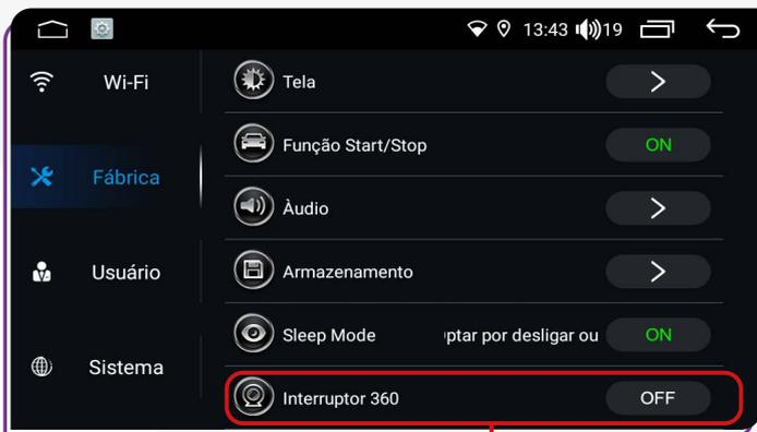
Função ativada para veículos equipados de fábrica com câmera 360°, permitindo uma visão completa ao redor do carro para facilitar manobras e estacionamento.
