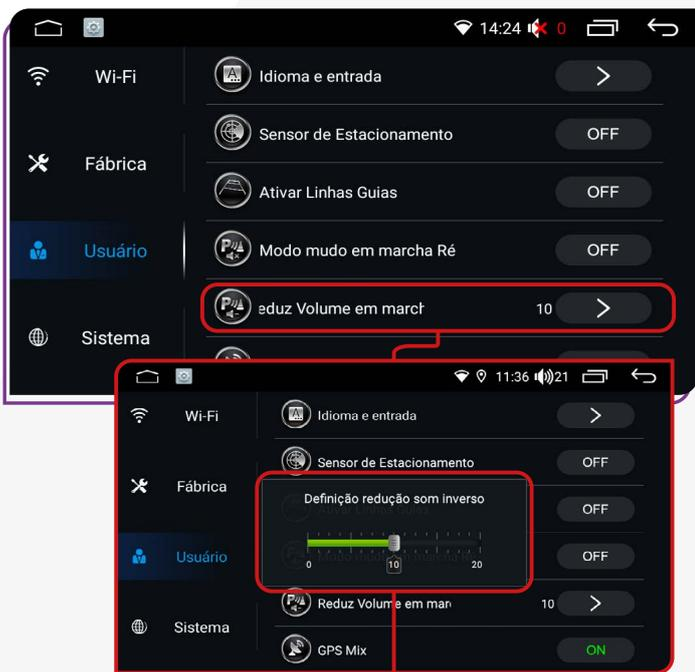
Ao personalizar a função **"Reduz Volume marcha Ré"** em uma escala de 0 a 20, quando a marcha ré for engatada e se houver música tocando, o volume do som será automaticamente reduzido.
