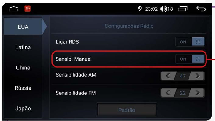
**Sensibilidade Automática:** Ativando essa função, podemos estar ajustando manualmente a sensibilidade tanto de AM como de FM. Recomendamos deixar essa função em modo automático.
