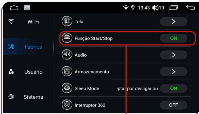
Quando houver diminuição da voltagem do veículo, o i-Cardtablet continuará ligado. Isso significa que mesmo quando o carro diminuir a energia em paradas obrigatórias durante a viagem, como em semáforos, a sua multimídia não vai desligar sozinha.
