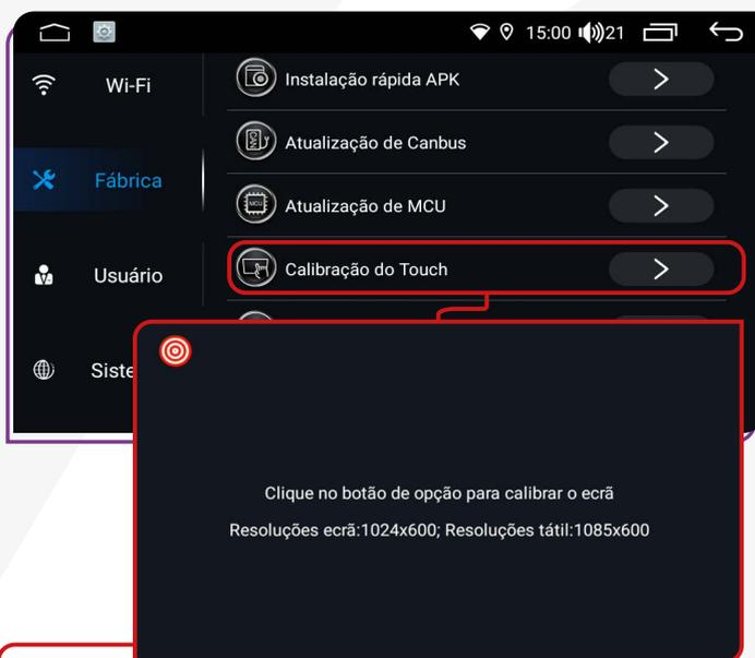
Ao clicar nessa função, é possível calibrar a tela do i-Tablet. Basta deslizar pelo caminho pontilhado vermelho, ao final do processo a tela estará calibrada.
