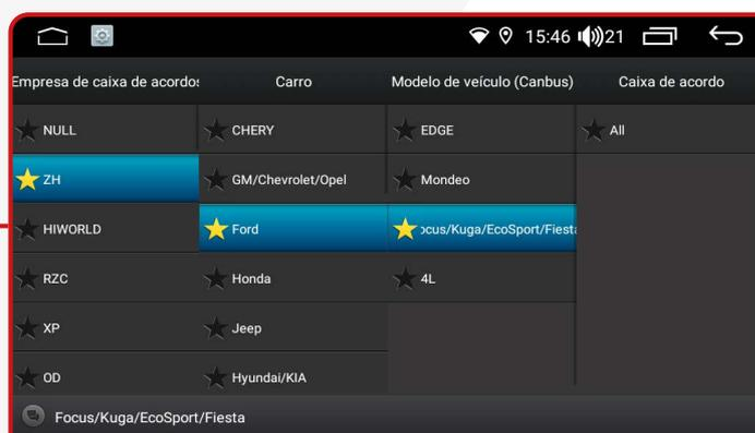
Ao acessar esta função, é possível configurar o modelo do veículo, garantindo uma integração mais eficiente entre as funções da multimídia e as características de fábrica do automóvel.
