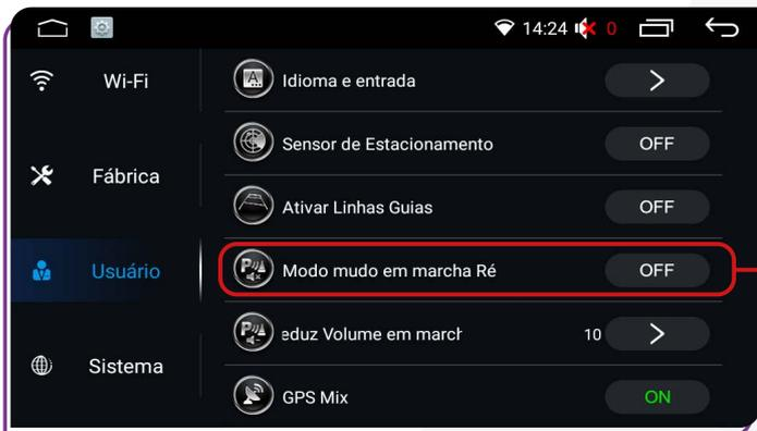
Ativando a função **"Modo mudo em marcha Ré"**, ao engatar a marcha à ré, o i-Tablet interromperá qualquer reprodução de som, entrando em silêncio. O áudio será retomado após a conclusão do procedimento com o veículo.
