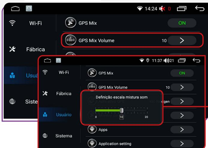
Com a antena GPS instalada no veículo, ao ativar a função "GPS Mix", você pode utilizar os sistemas GPS integrados na multimídia, obtendo uma localização mais precisa e utilizando com maior eficácia os aplicativos de GPS instalados no sistema.
