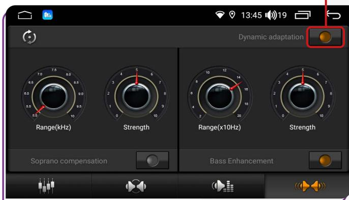
Para ativar o modo manual, ative a opção **Soprano compensation** e **Bass Enhancement**.
