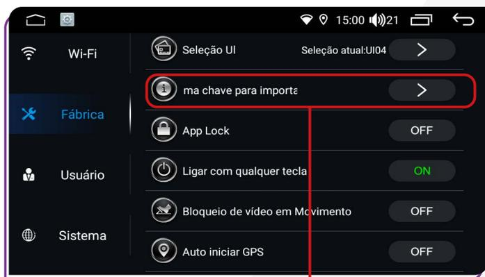
Função disponível somente para engenharia de fábrica. Função indicada para salvar a configuração da multimídia na memória interna para utilizar como configuração salva.
